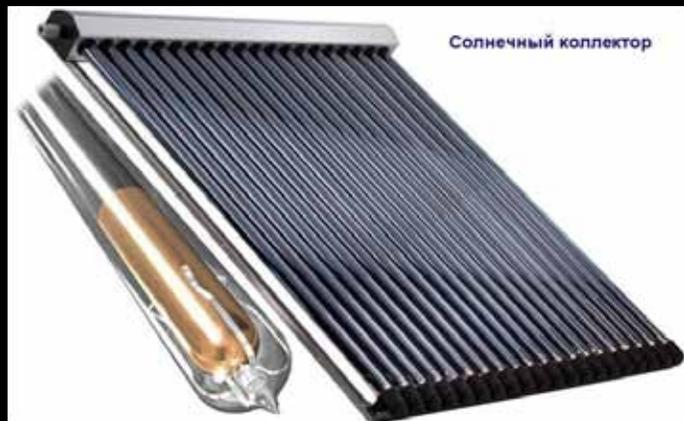
Вакуумный солнечный коллектор может повышать температуру теплоносителя до 250–300°С. Фактически солнечная тепловая труба имеет устройство, схожее с бытовыми термосами, только внешняя часть трубы прозрачна, а на внутренней трубке нанесено высокоселективное покрытие улавливающее солнечную энергию. Между внешней и внутренней стеклянной трубкой находится вакуум, что дает возможность сохранить около 95% улавливаемой тепловой энергии.
